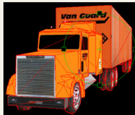
Objet optimisé faces supprimé à 90 % 1834 faces 1140 points
